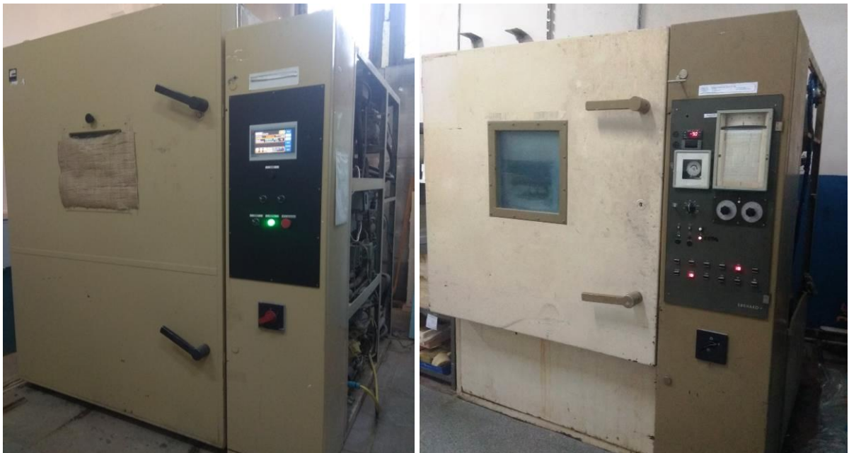
Рисунок 3 – Кліматичні камери для проведення циклічних кліматичних впливів
