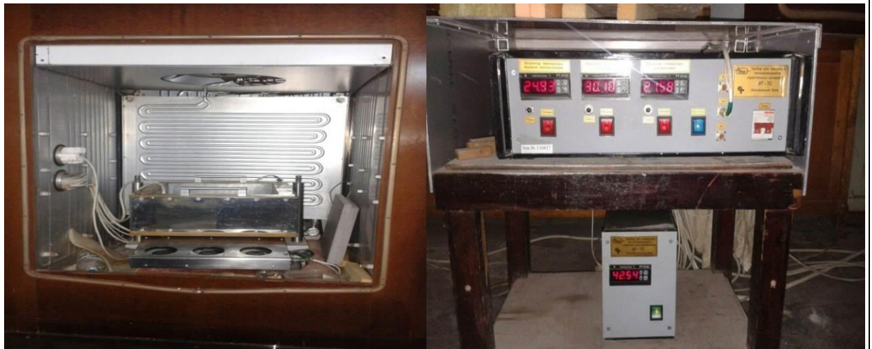
Рисунок 2 – Установка для визначення теплопровідності згідно з ДСТУ Б В.2.7-105-2000 (ГОСТ 7076-99)
