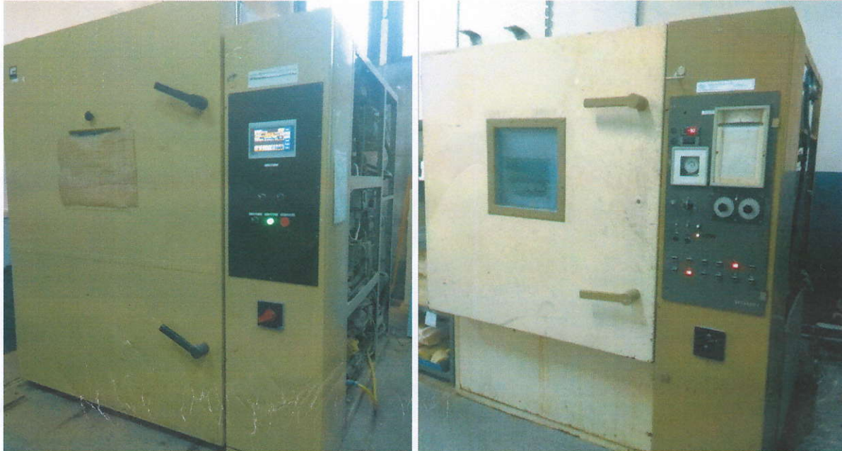
Рисунок 3 – Кліматичні камери для проведення циклічних кліматичних впливів
